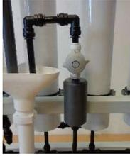
1. Desinfektionspumpe mit Desinfektionsstelle verbinden.
