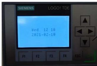
Zum Anzeigen der Uhrzeit und des Datums die Pfeiltaste nach unten drücken.
