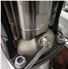
3. Schraube zur Pumpenentlüftung vorsichtig öffnen, bis ein Wasseraustritt festzustellen ist. Anschließend Schraube wieder schließen und Magnetspule wieder zurückstellen.
