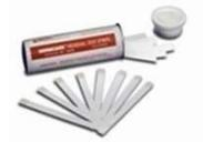
11. Anlage laufen lassen bis am Permedreiatableauf kein Desinfektionsmittel mehr nachweisbar ist. Hierzu Teststreifen Minncare residual verwenden.
