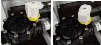
1. Eingangsventil manuell öffnen. Hierzu weiße Magnetspule um 45° gegen den Uhrzeigersinn drehen.
