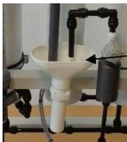
5. Am Permeatablauf mit Teststreifen auf richtige Desinfektionsmittelkonzentration prüfen. Hierzu Minncare Teststreifen Indication 1% benutzen.
