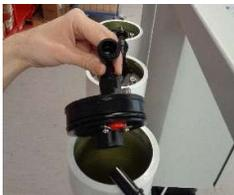
4. Steckverbindung trennen und Deckel abnehmen.
