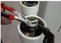
3. Moduldeckel mit Hilfe einer Kombizange anheben.
