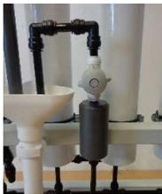
7. Absperrventil Permeat zum Abfluss schließen.
