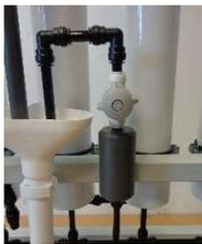
12. Absperrventil Permeat zum Abfluss schließen.
