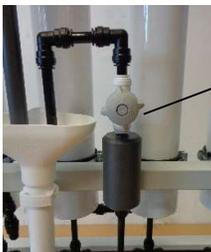
7. Absperrventil Permeat zum Abfluss öffnen.
