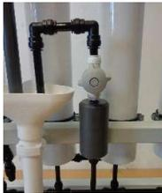
10. Absperrventil Permeat zum Abfluss öffnen.
